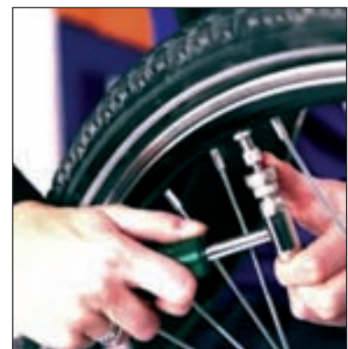
Doppelkopfaufsatz passt auf alle gängigen Ventile
